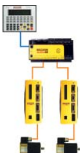
◀ Es gibt von Baldor eine Reihe von HMI (Human Machine Interface) Konsolen zum Anschluss über den CANopen Port. Weil Mint Bewegungen und I/O-Tasks gleichzeitig ausführen kann, eignet sich NextMove ESB hervorragend als kompletter Maschinencontroller.
